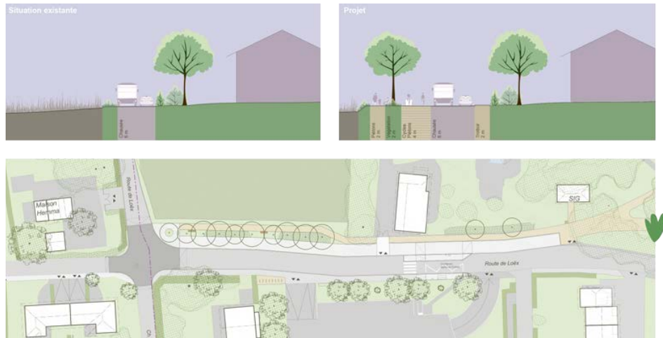
Situation existante: L'aménagement actuel de la route de Loëx constitue un obstacle à la mobilité douce. Projet: L'aménagement est repensé afin d'intégrer des trottoirs et des pistes cyclables dédiés.
